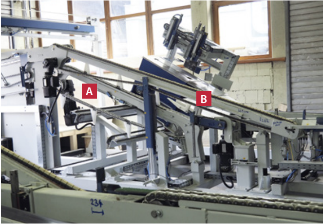
Transformation: Der Förderer mit Mitnehmer zur Bundbildung senkt sich ab (A) und der Förderer für die Einzelstücke fährt nach oben (B)
