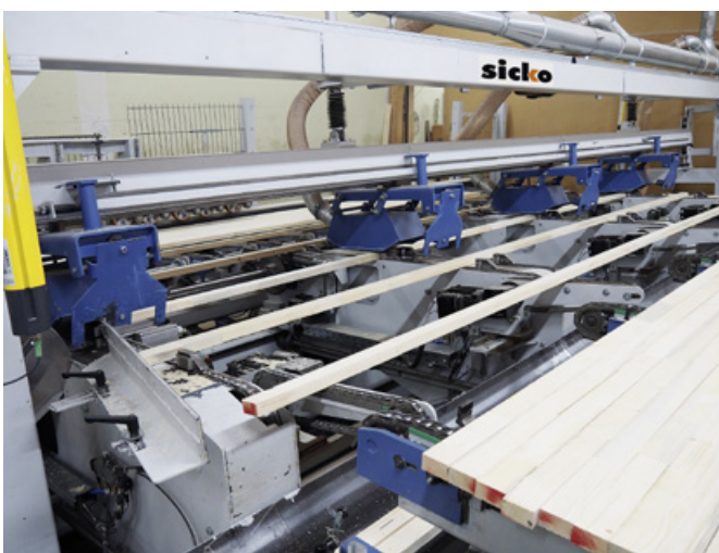
Bei der Einlaufmechanisierung installierte Sicko unter anderem eine Mehrfachablängsäge mit insgesamt vier Kappsägen
