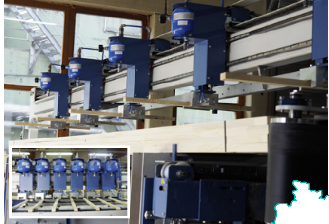
Lattenlegung bei der Paketierung mit sechs Greifer, bei Nichtgebrauch fahren sie nach rechts in Warteposition (kl. Bild)
