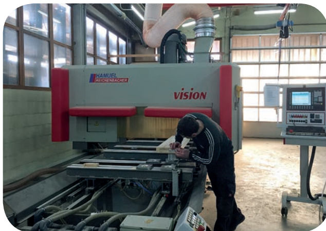
5-achs Portalmaschine für Treppen und Pfosten-Riegel
