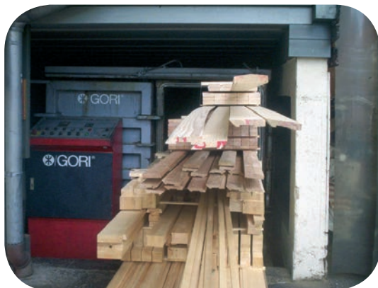
Gori-VacVac Imprägnieranlage Tiefenimprägnierung für maßhaltige Holzbauteile
